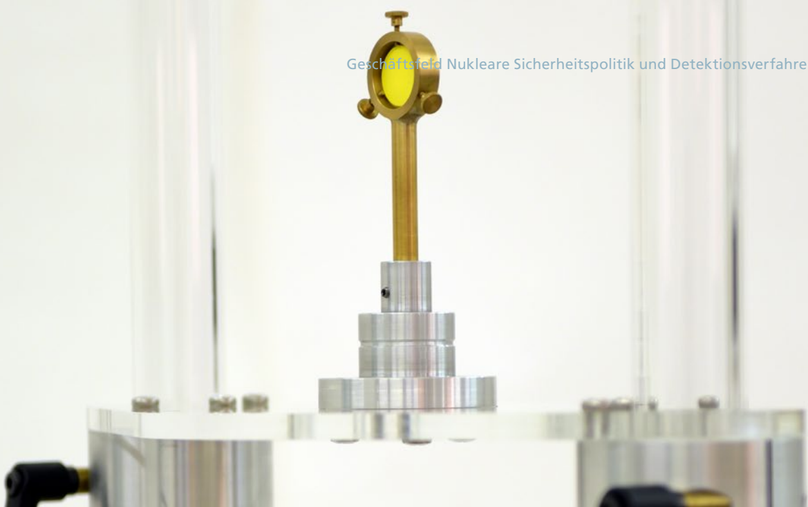
Quellenhalter des dynamischen Qualifizierungs-Testsystems für Strahlungsmessgeräte
