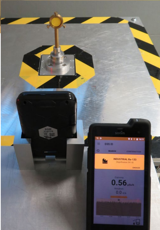
D3S vor radioaktiver Quelle (gelb) im Quellenhalter auf Quellenhebevorrichtung des QuTeSt.
